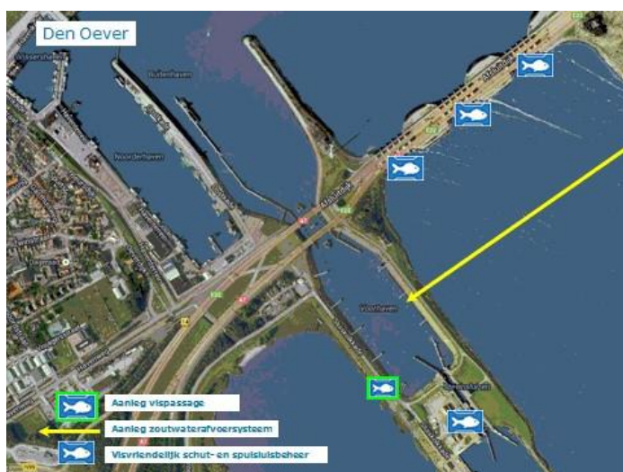
Figuur 12: Locaties maatregelen Den Oever: aanleg vispassage, aanleg zoutwaterafvoersysteem, visvriendelijk schut- en spuilsuisbeheer
